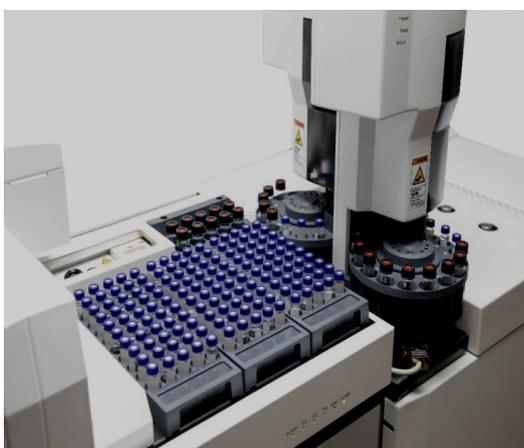
**Оснащен синхронными и асинхронными каналами для выбора режима ввода проб (до трех измерительных каналов):**
